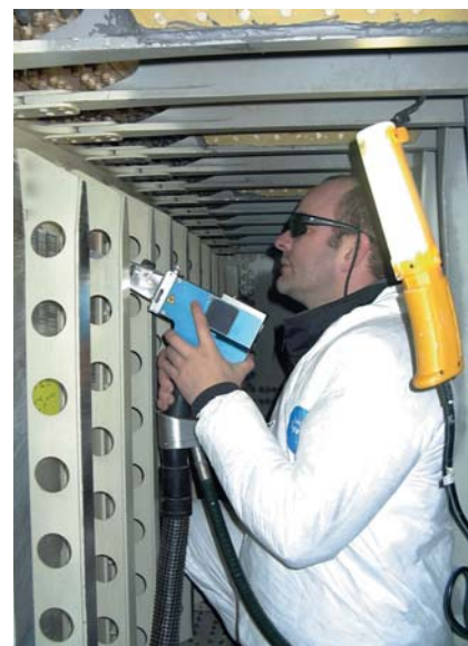
Mobiilse laseri CL 1000 abil saab puhastada mitmesuguseid pindu
